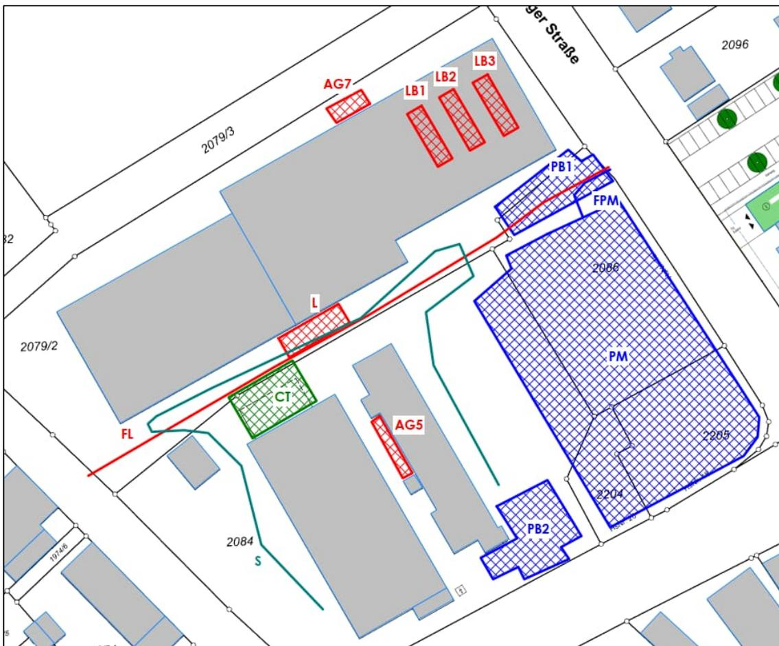
Abbildung 5: Lageplan mit Darstellung der relevanten Schallquellen
