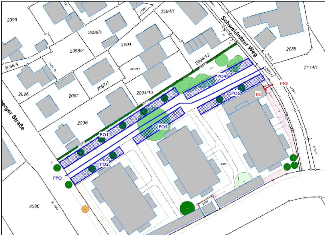
Abbildung 7: Lageplan mit Darstellung der relevanten Schallquellen der Parkanlagen der Wohnbebauung
