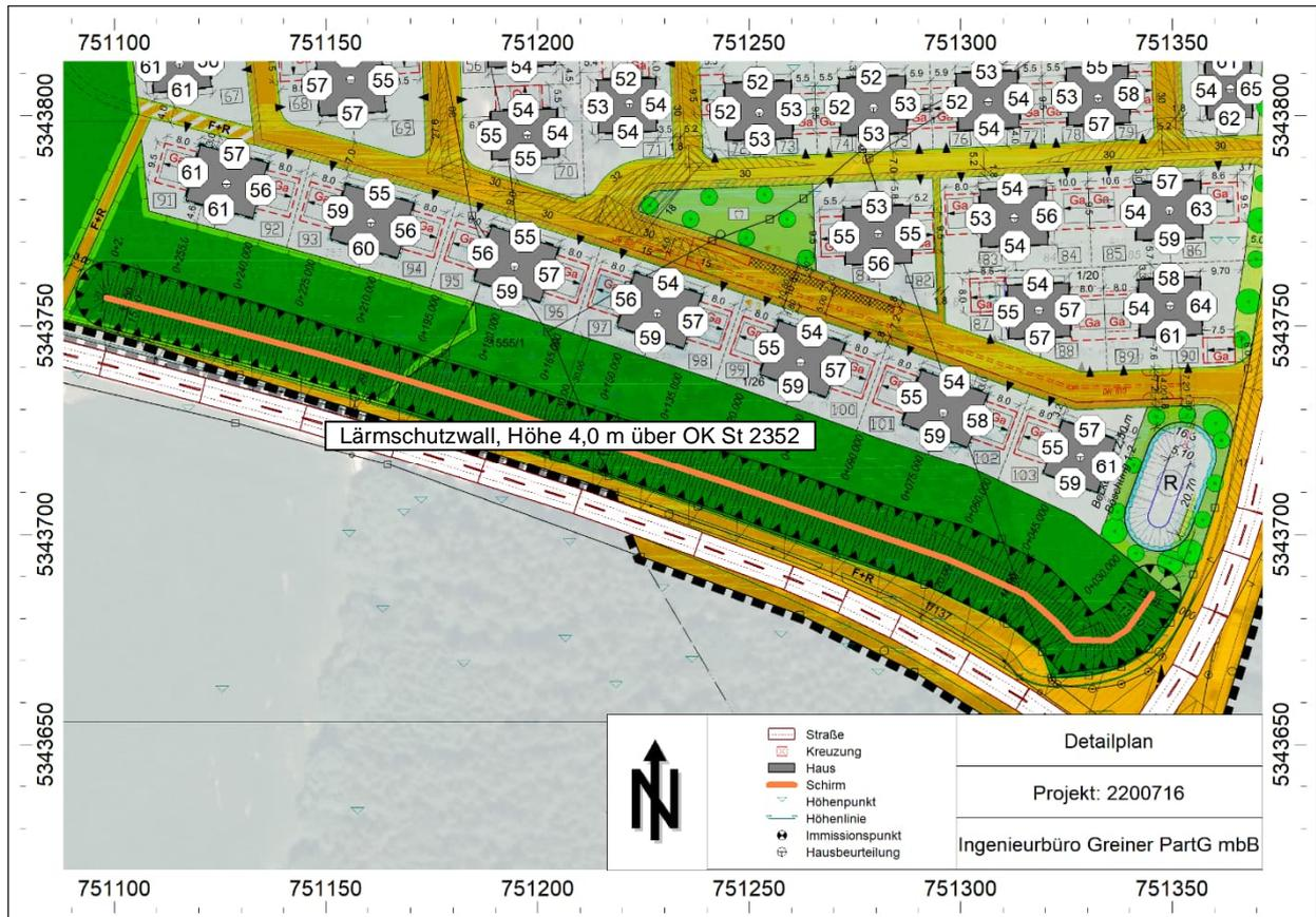
Gebäudelärmkarte Tag mit Lärmschutzwall (H = 4,0 m), Pegel in dB(A) im Erdgeschoss
