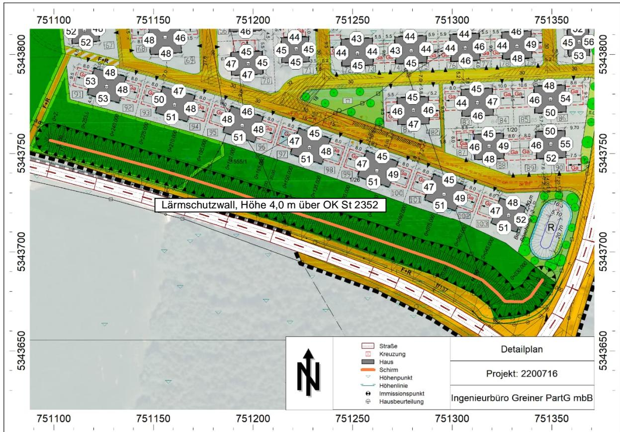
Gebäudelärmkarte Nacht mit Lärmschutzwall (H = 4,0 m), Pegel in dB(A) im Erdgeschoss
