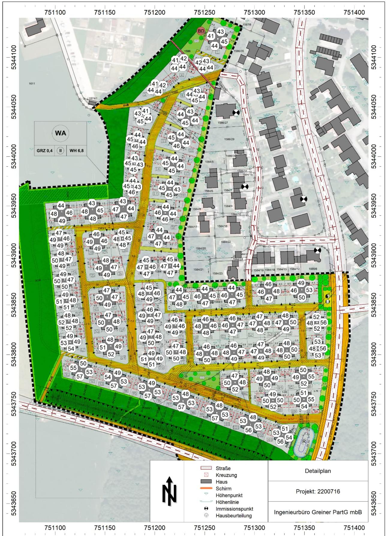
Gebäudelärmkarte Tag mit Lärmschutzwall (H = 4,0 m), höchste Pegel in dB(A) je Aufpunkt
