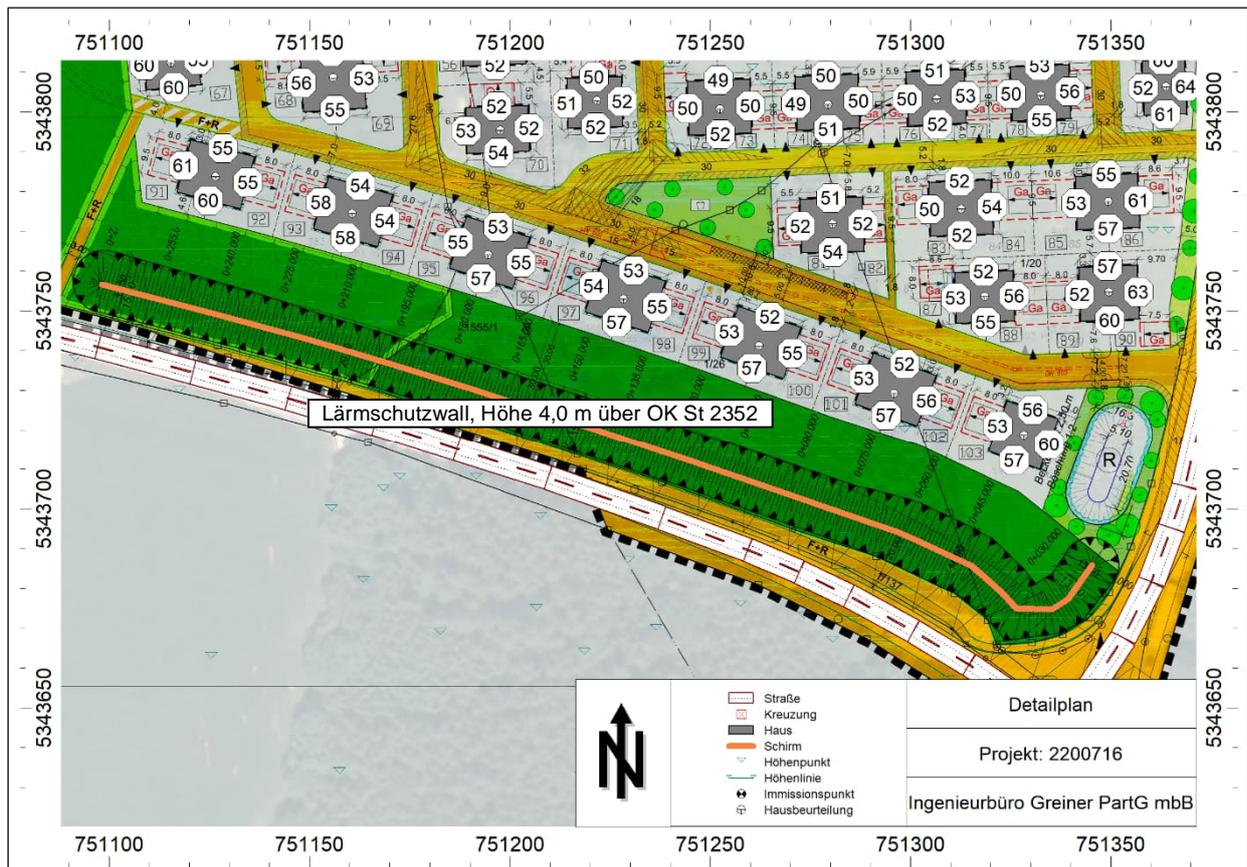
Gebäudelärmkarte Nacht mit Lärmschutzwall (H = 4,0 m), Pegel in dB(A) im 1. Obergeschoss
