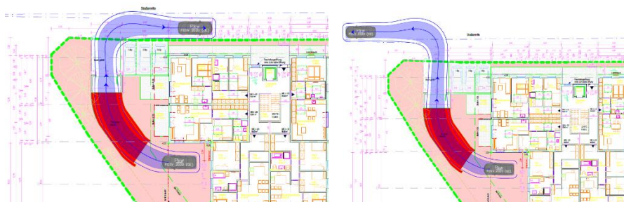
Abbildung 17: Schleppkurvenprüfung Tiefgarage Ausfahrt (Quelle Hintergrundplan: Architekturbüro Bubl)
