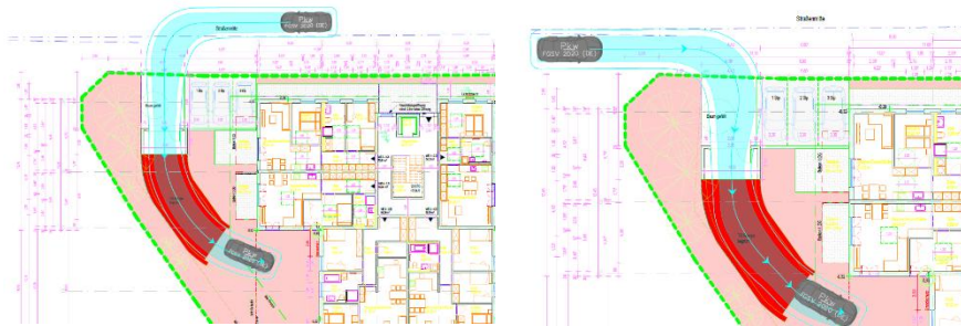
Abbildung 18: Schleppkurvenprüfung Tiefgarage Einfahrt (Quelle Hintergrundplan: Architekturbüro Bubl)
